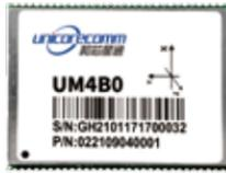
UM4B0 是和芯星通基于 Nebulas-II 高性能高精度芯片开发的全球最小的全系统全频 RTK 定位模块，支持 BDS B1/B2/B3、GPS L1/L2/L5、GLONASS L1/L2、Galileo E1/E5a/E5b、QZSS L1/L2/L5 等卫星信号。支持窄带抗干扰及惯导器件组合导航。主要面向轻型机器人、GIS 信息采集、智能驾驶和无人机等应用领域。
